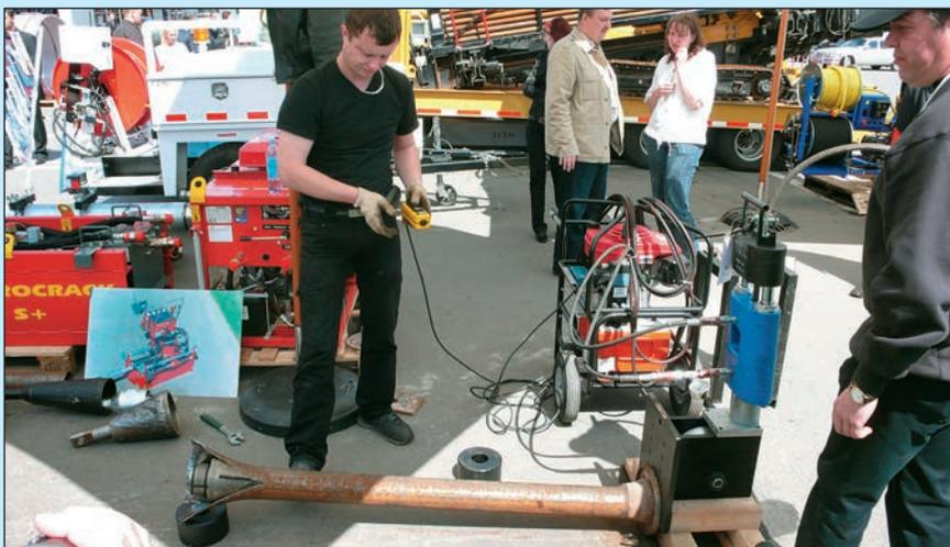
Желающие смогли отслеживать на манометре и усилии разрушения трубы, которое составляло не более 7 т для стальной трубы диаметром 150 мм. Стальную и чугунную трубу диаметром 100 мм установка разрушает при тяговом усилии 5-6 т.
