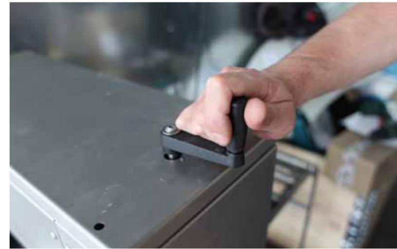
*Ручка регулирования положения валиков пропиточного стола*
