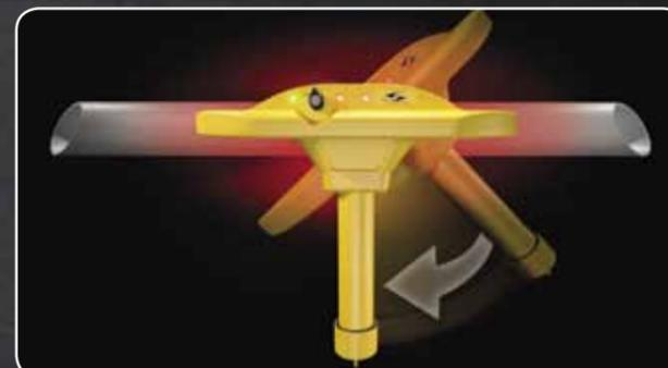
Шаг второй: Если активирован левый или правый светодиодный индикатор, вращайте локатор пока он не будет параллелен подземному объекту. Если локатор параллелен объекту, левый и правый светодиодные индикаторы активируются одновременно, срабатывает лазерный указатель и звуковой сигнал.
