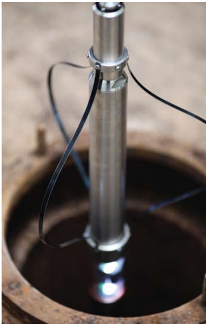
Камера с установленными с небольшим люфтом упругими направляющими готова к погружению на заданную глубину
