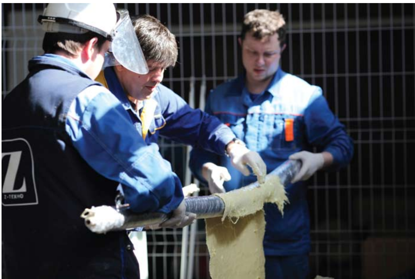
Накручивание пропитанного отрезка стекловолокна на внешнюю поверхность пакера
