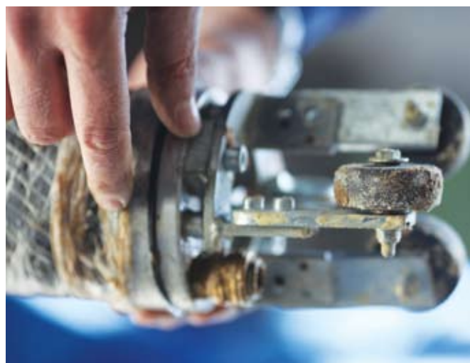
Роликовые шасси в торцевой части конструкции пакера для «безопасной протяжки» внутри трубопровода на большие расстояния
